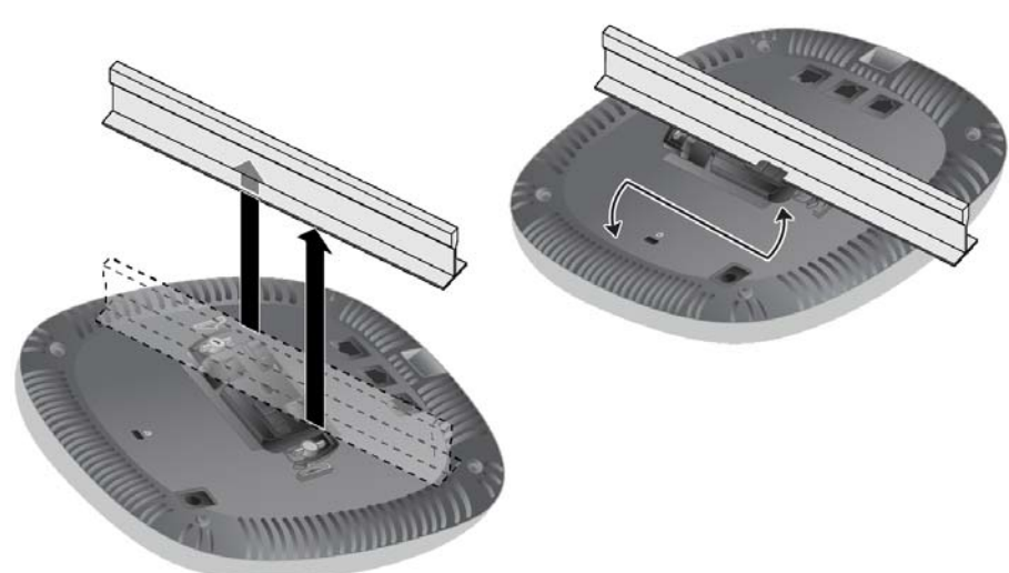
Figura 7 Montaje del punto de acceso
