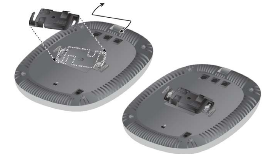
Figura 6 Instalación del adaptador de raíl para techo
